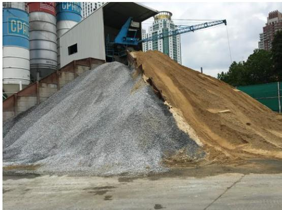
細骨材と粗骨材のヤード
